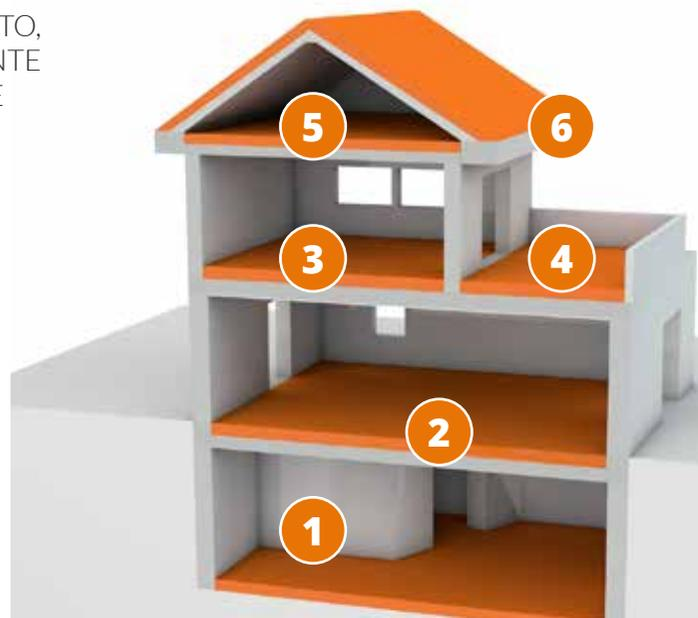
**Diakon** è il tappetino per fonoisolamento al calpestio e utilizzato in abbinamento a **Diathonite Massetto**, permette di isolare in modo efficace dai rumori di calpestio, realizzando un "pavimento galleggiante".
